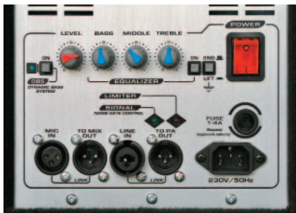
Manipulatory i przyłącza zestawu szerokopasmowego APS-415. Znajdziemy tu także wskaźnik aktywności limitera dla toru niskich częstotliwości oraz diodę sygnalizującą działanie bramki szumów w torze wysokich tonów.
